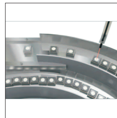
检测LED灯珠的正反面
